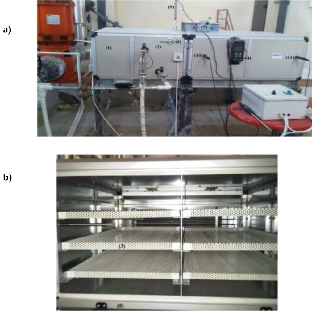
Şekil 3. a) Jeotermal kurutucu görünümü, b) Kurutma tepsilerinin görünümü (Helvacı vd., 2013).
